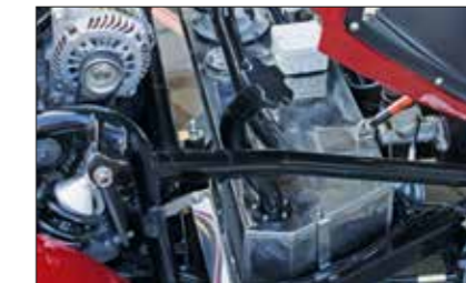
Anbauteile: über 50 neue Edelstahlteile anstatt verzinkter oder beschichteter Teile, wie Edelstahltank, Dehnungsbehälter, Motorhalter, Getriebehalter, Motorverblendung, Kühlerverkleidung, Handbremshebelverkleidung, Luftleitbleche, diverse Kleinteile sowie sämtliche Befestigungsteile.
