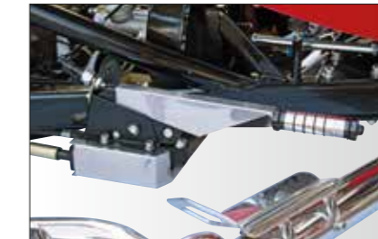
Handbremse: Edelstahlabdeckung und Edelstahlgriff.
