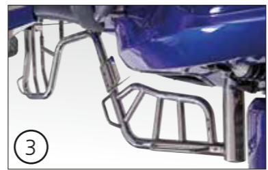
Beinschutz- und Gepäckaufnahmebügel VA Ø 60 mm
