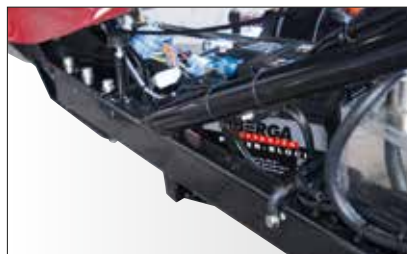
Rahmen: Kunststoffbeschichtet nach Automobilstandard (Salzsprühtest 600 h). Erhöhter Korrosionsschutz durch 4-Phasen-Bearbeitung. Dicke Wandstärken, verwindungssteif und optimale Fahreigenschaften.
