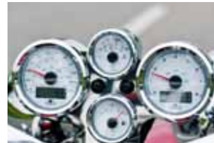
Die neue Generation: VDD-Instrumente in Marinequalität. Laut Hersteller beschlagfrei und mit genauer Tankanzeige. Integrierter Bordcomputer, Zeituhr, Voltmeter – alles ab sofort serienmäßig.
